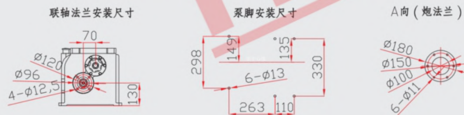
安装尺寸 / Installation dimension
